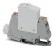
УЗИП типа 2/3, в комплектации из защитного штекера и базового элемента, со встроенным индикатором состояния и датчиком удаленного оповещения для однофазных электрических сетей. Номинальное напряжение 230 В AC/DC.
